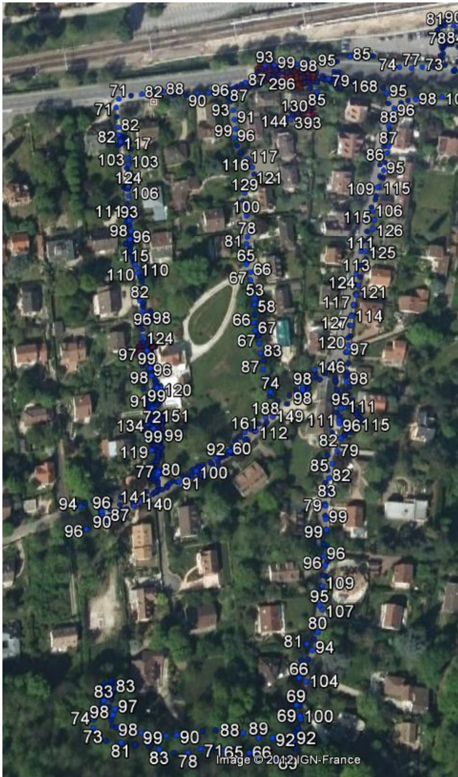
Mesures d'ambiance Colibri avec sonde bas bruit de fond (valeurs en nSv/h) Valeur maximum 393 nSv/h (distance 1 m du sol)
